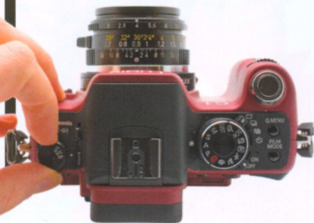
Die G1 Blendenvorwahl (A) einstellen und auf manuellen Fokus schalten
